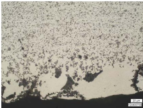
Bild 15 Gefüge von Schaltstücken am Ende der Lebensdaueruntersuchungen AC-3 (oben) und AC-4 (unten)
